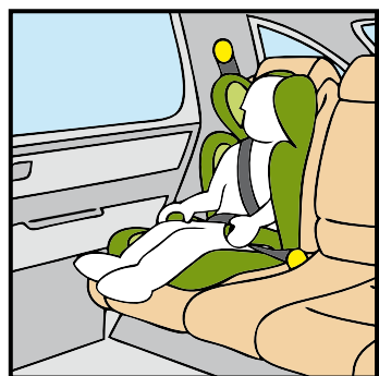
Sitzerhöhung mit integrierter Rückenlehne und Seitenaufprall-Schutz.
