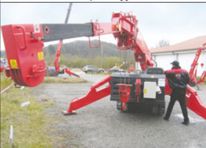
Der Unic URW-706 wird in Transportstellung gebracht
