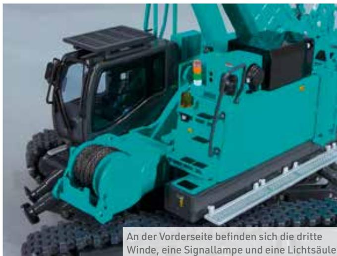
An der Vorderseite befinden sich die dritte Winde, eine Signallampe und eine Lichtsäule
