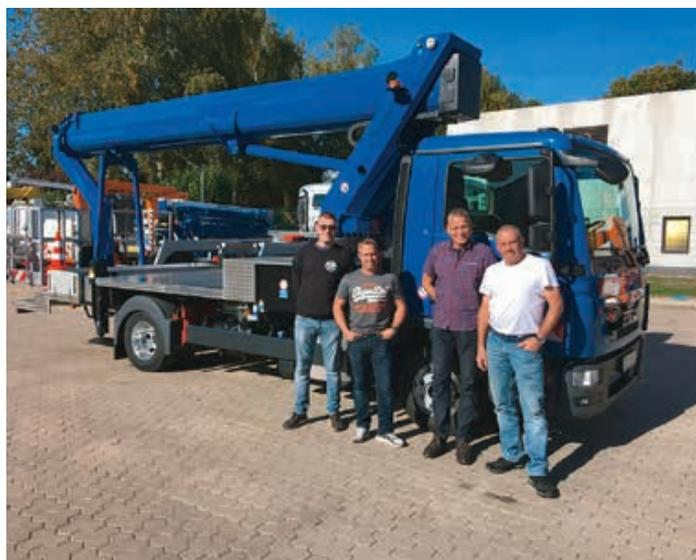
Die Firma **Hees + Knoll Dachtechnik** aus Holzappel bei Limburg an der Lahn hat sich erstmalig für einen „Steiger“ aus dem Hause **Ruthmann** entschieden, einen T 330 mit 33 Meter Arbeitshöhe und einer seitlichen Reichweite von gut 21 Metern. <<
