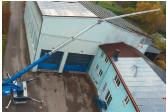
» Schmid Hebebühnenverleih aus Haimhausen hat seinen ersten Anhängerkran in Betrieb genommen. Es handelt sich um einen AHK 30/1500 von Böcker mit einer maximalen Hakenhöhe von 30 Metern, einer Nutzlast von 1.500 Kilogramm und einer Reichweite von bis zu 25 Metern. Der erste Anhängerkran im Mietpark soll die Einsatzgebiete der vorhandenen Minikrane erweitern, so das Unternehmen.
