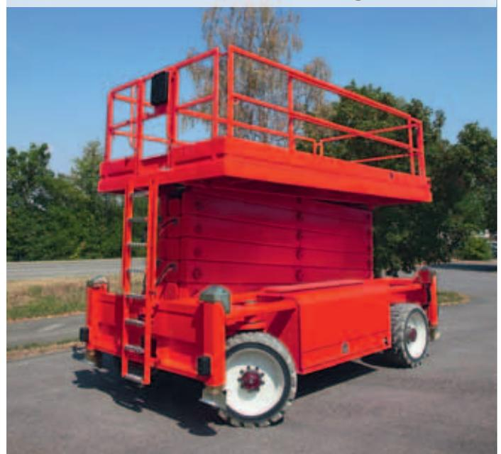
» Für Vamasa-Geschäftsführer Victor Cambra Balaguer war vor allem eines entscheidend: „Beim Modell PB S171-12ES ist besonders der Aufbau des Scherensystems herausragend, welches mit unterschiedlichen Scherenpaketen oben und unten eine Gewichtsreduzierung erzielt und somit die leichteste Maschine auf dem Markt ist. Da der Schwerpunkt so tief wie möglich liegt, wird zudem eine hohe Standsicherheit erreicht.“
