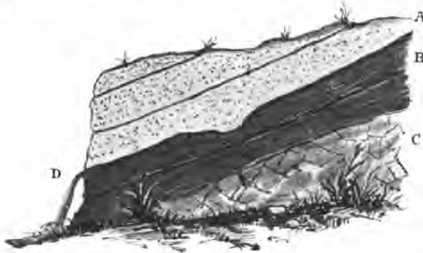
Obr. 51. Vrstvy půdy. Vrstvy A představují horninu propustnou, např. pískovec; vrstvy B, vrstvy nepromokavé, např. tučný jíl; C prahorninu. U D vytryskuje pramen.
