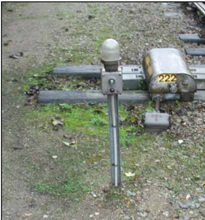
Centralaflåst sporskifte med el-stedbetjening
