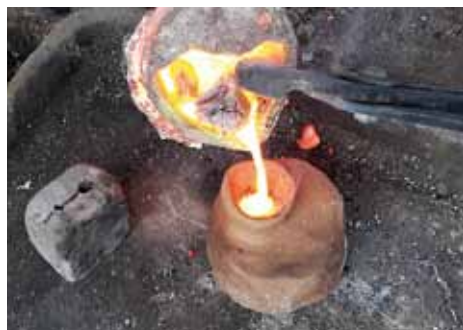
Obr. 4 Odlévání bronzu do ztracené formy Pic. 4 Pouring off bronze to a lost form
