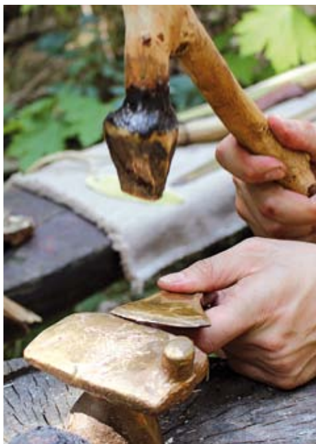
Další úprava bronzových nástrojů. Kování ostří sekerky pomocí kladívka vyrobeného z nálitku při jejím odlévání na bronzové kovadlině. OP Further treathing of bronze tools. Blacksmithing of axe with interim hammer (created during axe casting) on the bronze anvil
