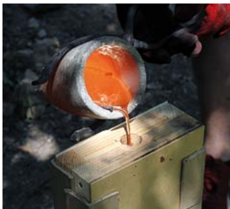
Lití roztaveného bronzu do pískové formy. OP Bronz casting in the sand mould
