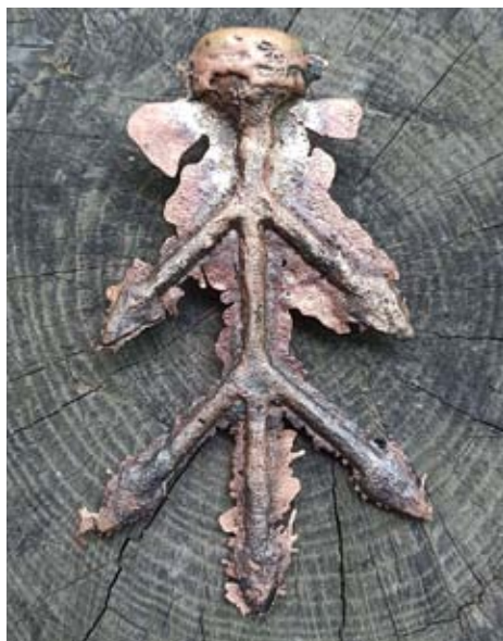
Bronzové hroty šípů po vyjmutí z odlévací formy Bronze arrow heads after removal from the casting mold
