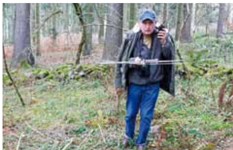
Zaměřování signálu sýčků z VHF vysílačů pomocí ruční antény Catching a signal from little owls from the VHF transmitters using a hand antenna
