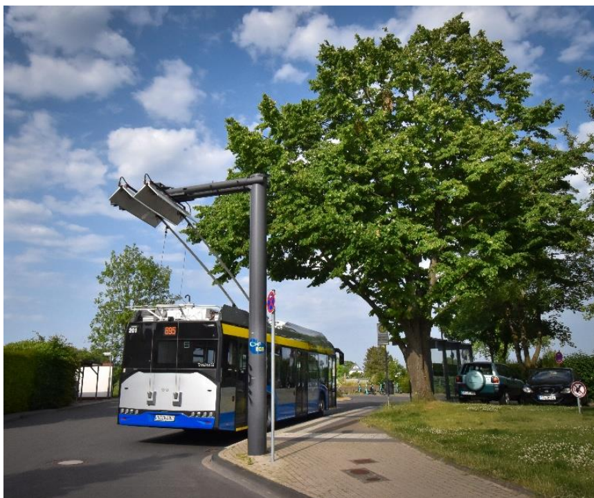
Obrázek 14.2: Dobíjecí stanoviště trolejbusů v německém Solingenu
