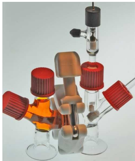
Laboratorní provedení baterie na vzduch. Kredit: Felice Frankel / MIT.ABBattery
