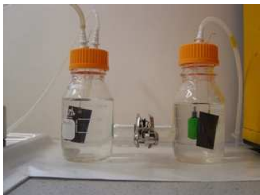
Demonstrační skleněný (funkční) palivový článek ve kterém lze pozorovat proces během kterého mikrobi z odpadních produktů vyrábí elektrický proud
