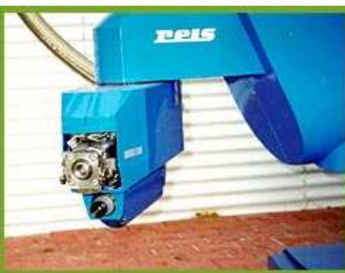
Detail výdejního stojanu kapalného vodíku
