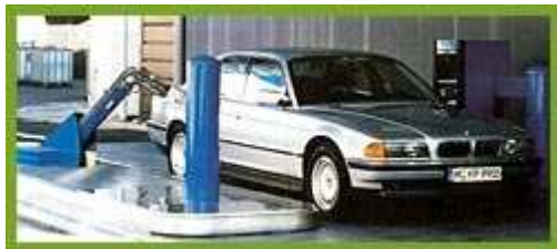
Plnění vozidla kapalným vodíkem
