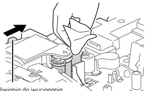
Dźwignia do wyciągania zaciętego profilu
