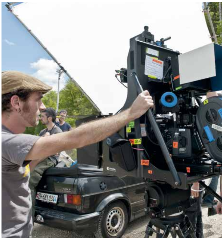
Gedreht wurde mit dieser 50 kg schweren Eigenkonstruktion: Zwei Kameras sind in einem 90°-Winkel so angeordnet, dass sie über einen halbdurchlässigen Spiegel denselben Bildausschnitt einfangen können
