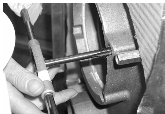
Bild 3: Gewinde M 12 ca. 30 mm schneiden
