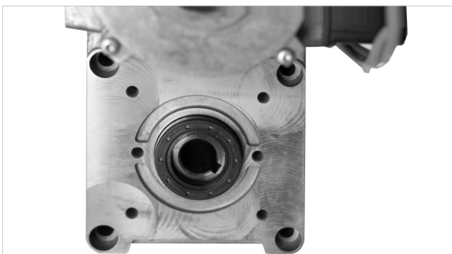
Abb. 5: Dichtring gerade aufgelegt
