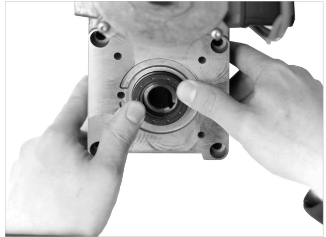
Abb. 6: Dichtring gleichmäßig eindrücken
