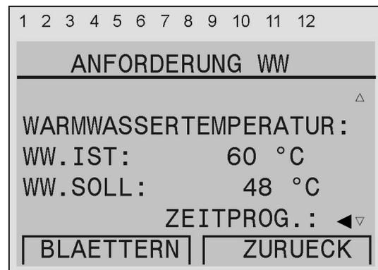
**Bild 35:** An der Cursor-Position ◀ durch Drücken des Rades das Warmwasserpuffer-Nachheizzeit-Menü aufrufen.
