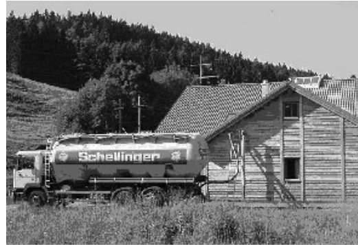
Anlieferung von Pellets im Pelletsilowagen
