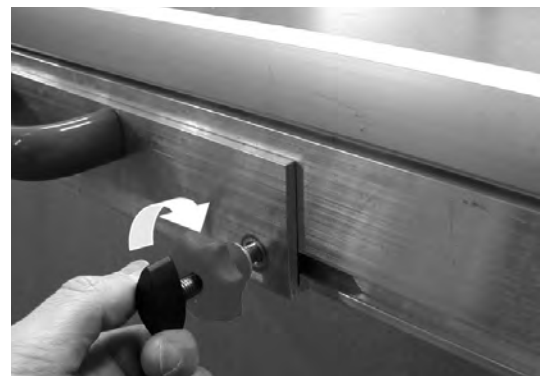
Figura 2: Avvitamento della vite con testa a martello
