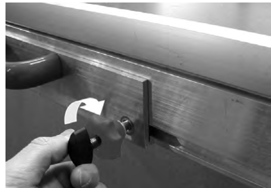
Figura 2: Girar el tornillo de cabeza de martillo
