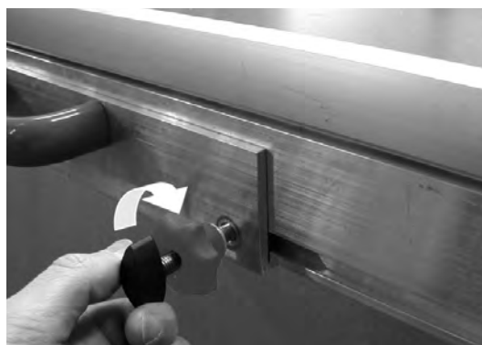
Illustration 2 : Serrage de la vis à molette
