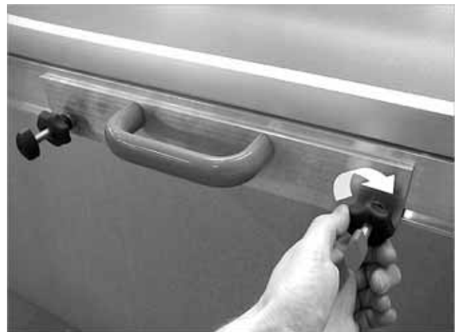
Abb. 4: Festziehen des Kollektorgrieffs
