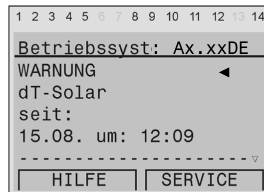
Bild 47: Störung im Solarkreis (Trotz Wärmeüber- schuss am Kollektor keine Zirkulation)
