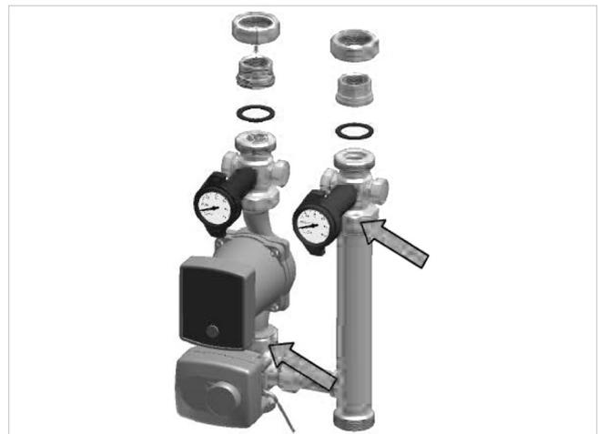
Abb. 4: Verschraubungen lösen
