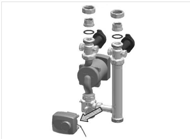
Abb. 6: Antriebseinheit vom Mischer abziehen
