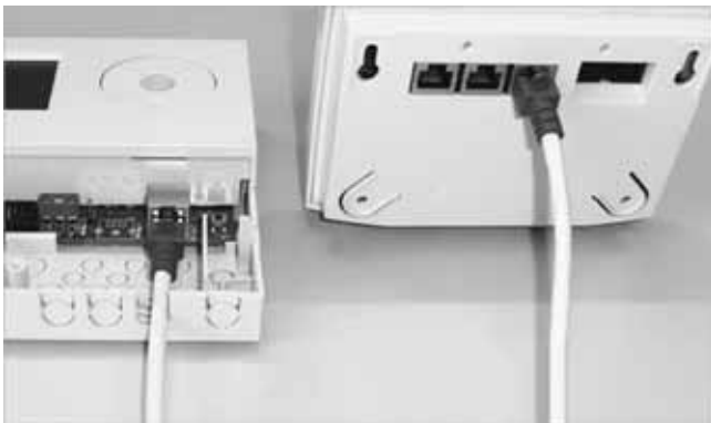
Abb. 1: Netzwerkanschluss an SolvisControl
