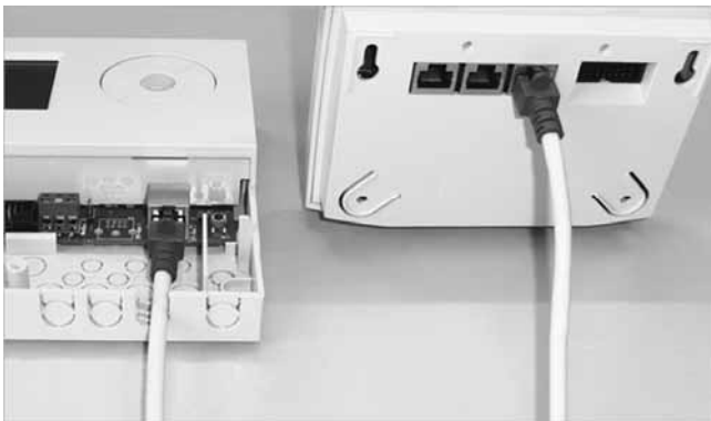
Abb. 4: Netzwerkanschluss an SolvisControl
