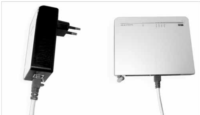
Abb. 7: PowerLine-Adapter mit Router verbinden
