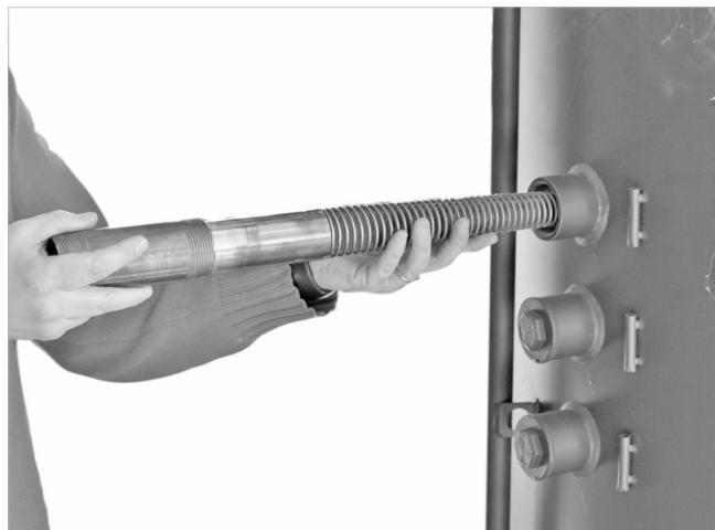
Afb. 13: Laadlans inschuiven en afdichten
