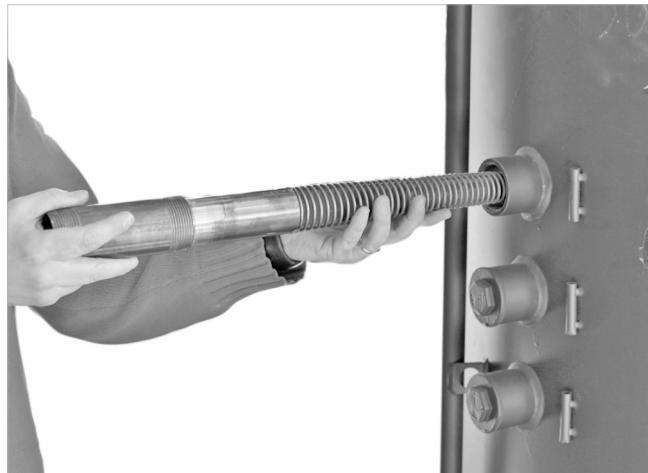
Abb. 1: Beladelanze einschieben und eindichten
