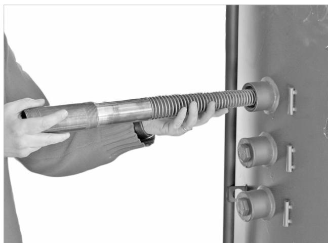
Fig. 5: Inserire la lancia di carico ed ermetizzarla
