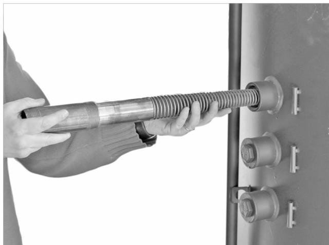
Fig. 7: Introducir y sellar la lanza de carga
