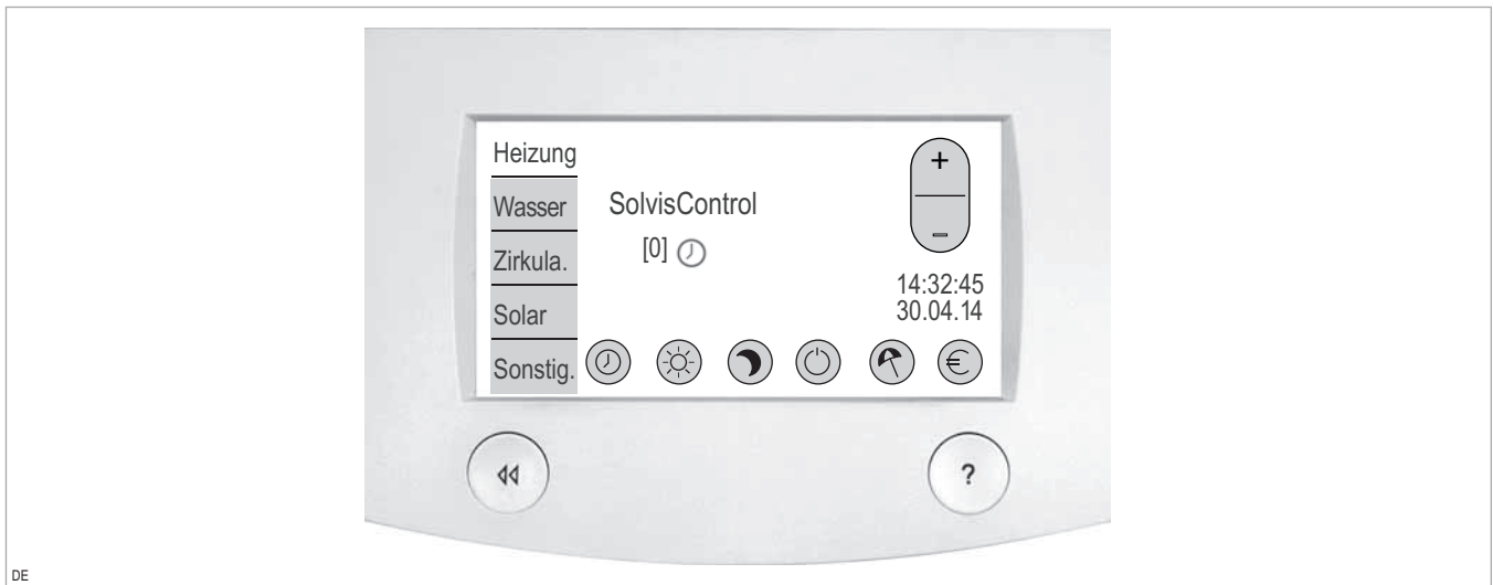
Abb. 2: SolvisControl mit Menü „Heizung“
