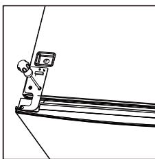
9. Coja la tapa de la biagra izquierda de la bolsa de accesorios e intálela encima de la bisagra. El tapa del agujero de instalación queda al lado derecho.
