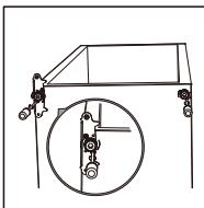
6. Cambie en 180ºC la dirección de la bisagra intermedia, luego póngala en la posición correcta a la izquierda. Ponga el perno de la bisagra en el agujero superior de la puerta de abajo, luego fije los tornillos.
