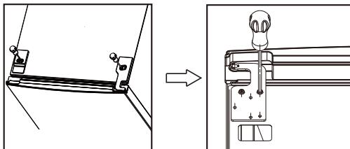
2. Destornille la bisagra intermedia con el destornillador de estrella, luego saque la puerta inferior.
