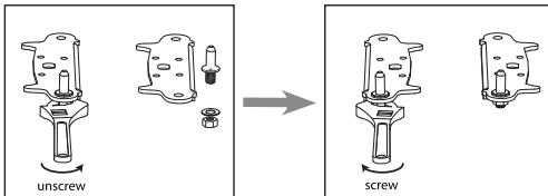
5. Inserte el soporte encajando con el perno inferior de la bisagra. Cambie los dos pies de nivelación. Coloque la puerta inferior en la posición correcta.
