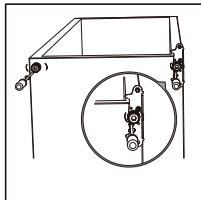
4. Destornille y saque el perno inferior de la bisagra, gire el soporte y cámbielo.
