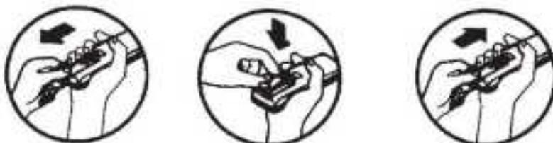
1. Abra la cubierta deslizándola en el sentido que indica la flecha.
