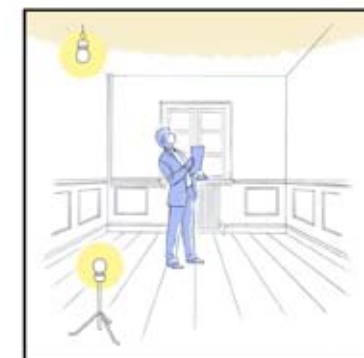
Bedömning av tak i artificiellt ljus. Observera att belysningskällan ska vara placerad bakom besiktningsmannen.
