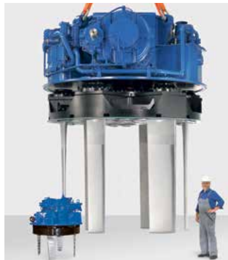
Hélice de type VSD de Voith Schneider, de grandes dimensions, fabriquée par Voith Turbo Schneider Propulsion.
