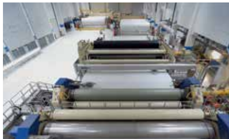
Sur les immenses machines à papier, la production régulière est assurée le réglage des tensions du ruban, le revêtement des cylindres et les râcles réglant la surface du papier.
