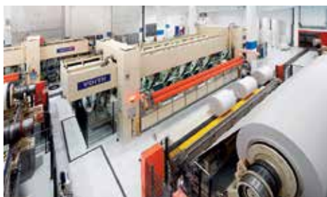
A la fin du processus de fabrication, le large rouleau de papier est débité en continu sur des coupeuses de Voith en bobines plus petites, qui sont ensuite emballées et expédiées.
