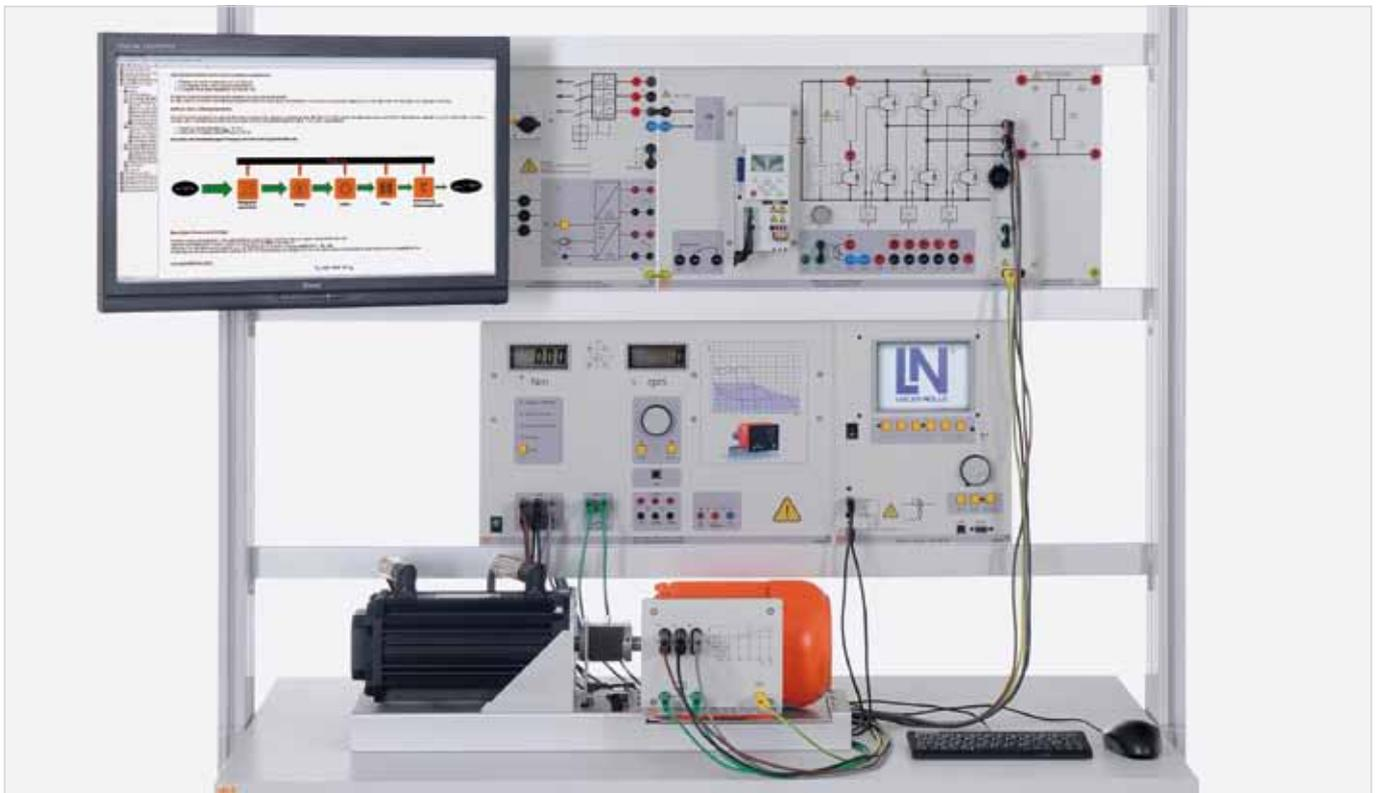
Système d'apprentissage « Entraînements à efficacité énergétique avec convertisseurs de fréquence », composé d'un moteur hautement efficace et d'un banc d'essai de machines à servocommande
