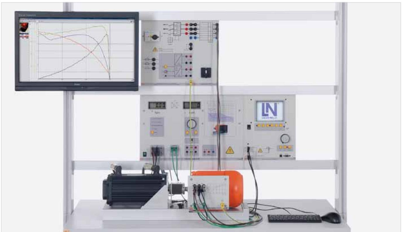
Système d'apprentissage « Moteur économique en énergie », composé d'un moteur hautement efficace et d'un banc d'essai de machines à servocommande.
