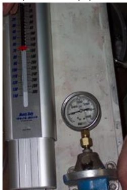
Original Scott bremse mastercylinder. Bremsetryk med original Scott master er ca. 500 psi, når bremsepedal påvirkes med 150 lbs.
