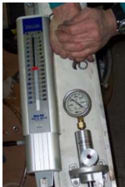
Modificeret bremse master fra Steve's Aircraft. Bremsetryk med opdateret model fra Steve's aircraft er på 1100 psi med 150 lbs på bremsepedalen - mere end en fordobling.
