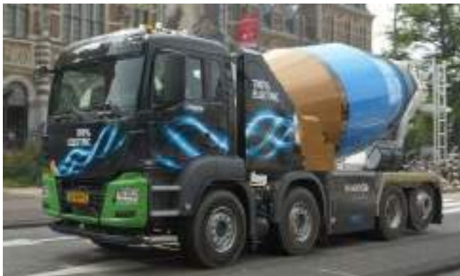
Figuur 10: Elektrische truckmixer van Kijlstra Overgenomen uit: Kijlstra levert mortel met elektrische betonmixer compleet stikstofvrij af door A. Tissink, 2020. Geraadpleegd op 6 november 2023, van: ( https://www.cobouw.nl/287691/.nl/287691/kijlstra-levert-mortel-met-elektrische-betonmixer-compleet-stikstofvrij-af ). Copyright 2020, Cobouw (Tissink, 2020).
