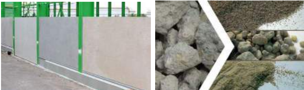
Figuur 17a: Een wand met v-l-n-r: geopolymere beton met 98% secundair materiaal, wapening met basalt, hybride beton met restmateriaal vanuit recycling asfalt en gecalcineerde klei bij Voorbij Prefab en Figuur 17b: Bestanddelen na slim breken met de Smart Crusher
