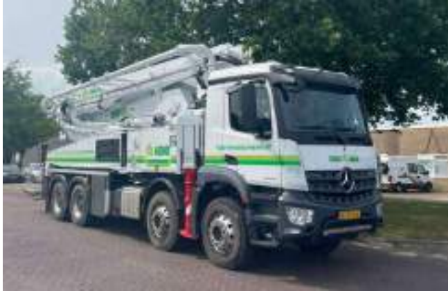
Figuur 11: Elektrische betonpomp voor Faber Overgenomen uit: Eerste elektrische betonpomp in Europa staat bij Faber Betonpompen door Faber, 2022. Geraadpleegd op 6 november 2023, van: ( https://betonhuis.nl/betonmortel/eerste-elektrische-betonpomp-europa-staat-bij-faber-betonpompen ). Copyright 2022, Betonhuis.
