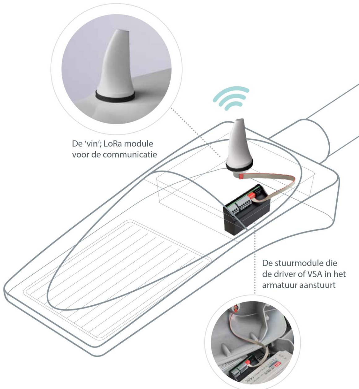
Afbeelding 1: Onderdelen van de LoRa TeleController
