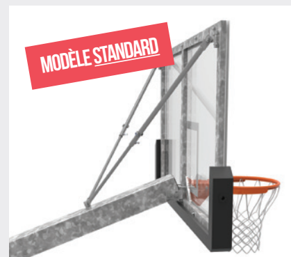
Version standard : testé à 320 kg selon la norme, 2 jambes de forces et pas de renfort du mât
