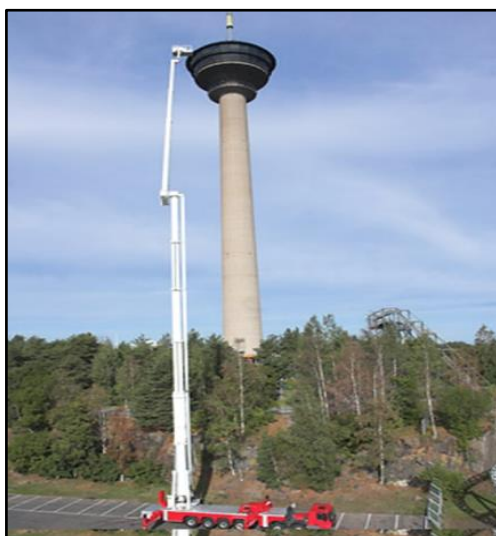
Telescopisch kraanhoogwerker voor extra lengte
