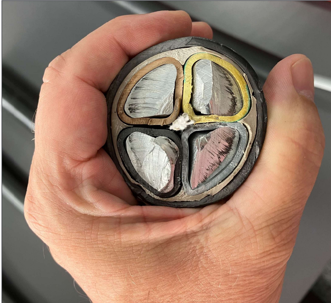
Querschnitt eines Mittelspannungskabels aus Aluminium 4 x 95 mm 2 SE
