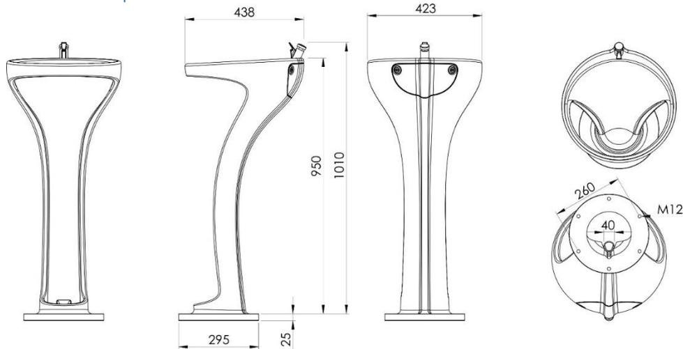
Brunnenkörper: Ring oben  $\varnothing$  423mm, Fuß  $\varnothing$  295mm
