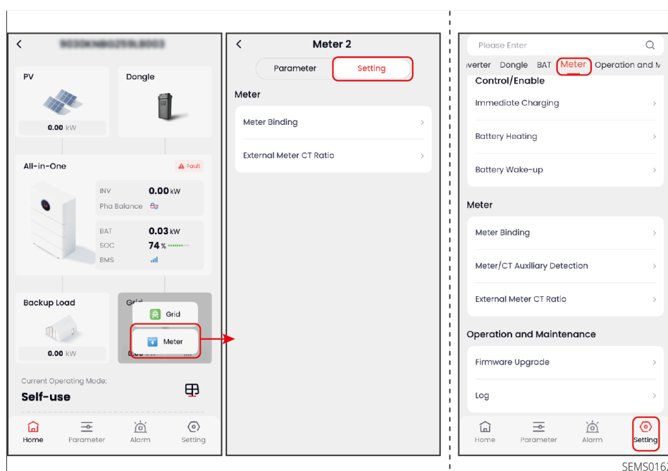
Figura33 Impostazione dei parametri del contatore elettrico
