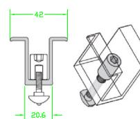
Morsetto di fissaggio terminale
