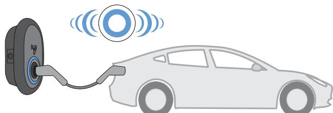
**5 -** La carica si avvia e il LED dell'indicatore di stato si illumina di blu.
