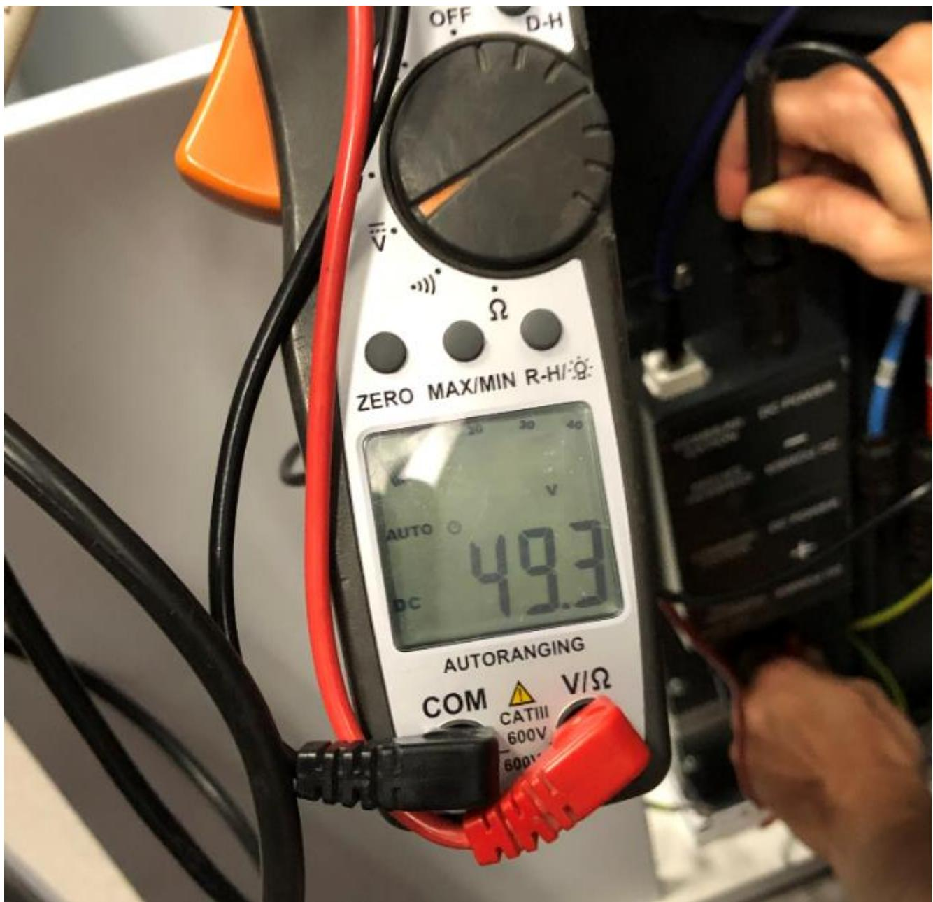
Se le batterie hanno una tensione normale, procedere a verificare la continuità dei cavi di potenza che fanno da collegamento tra le varie batterie. Un errato contatto su uno di questi cavi potrebbe essere la causa dei valori errati di tensione rilevati.
