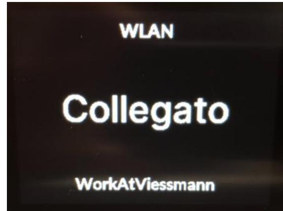
È possibile verificare lo stato della procedura anche dal display dell’inverter. Al termine della connessione verrà visualizzata l’indicazione **SETUP WI-FI RIUSCITO**.
