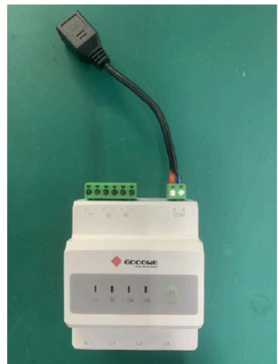
Collegare i cavi di rete del pacchetto accessori alla porta Meter dell'inverter MASTER e alla porta dell'adattatore GM330.
