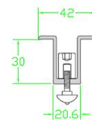
Morsetto di fissaggio terminale
