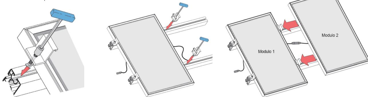
Particolare meccanico modulo Vitovolt M-WM dim. 1.812x1.096x30mm
