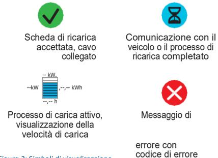
Figura 2: Simboli di visualizzazione dello stato
