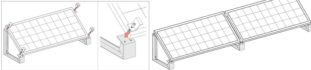
Per semplificare il montaggio delle staffe ferma-pannello sono presenti delle aole sulle estremità. Per aumentare la resistenza alle forze laterali risulta possibile prevedere dei tiranti per controventatura.
